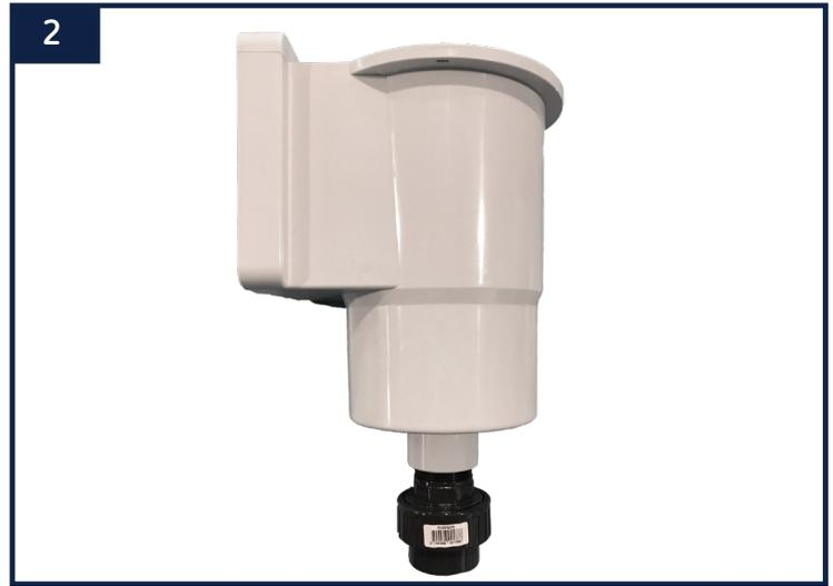
Vissez le raccord Union PVC male Ø50 mm 1'1/2 à votre skimmer. Afin d'assurer une parfaite étanchéité, il sera nécessaire d'appliquer au préalable un joint d'étanchéité en téflon sur le filetage de votre raccord. Pour réaliser correctement cette étape, n'hésitez pas à demander conseil à votre revendeur.
