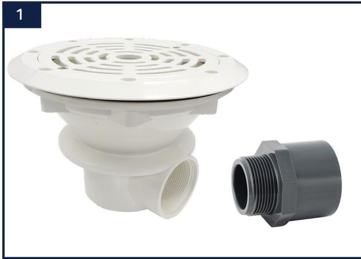
La bonde de fond de votre piscine sera raccordée à la vanne de bonde de fond installée en amont de votre pompe de filtration. Pour la raccorder correctement, vous devrez utiliser l'embout fileté PVC male Ø50 2", de la colle PVC et un tuyau d'évacuation.
