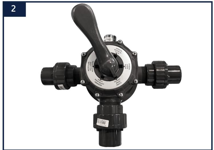
Vissez les 3 raccords union PVC 3 pièces mixte Ø63/50 2" aux 3 extrémités de votre vanne 6 voies. Afin d'assurer une parfaite étanchéité, il sera nécessaire d'appliquer au préalable un joint d'étanchéité en téflon sur le filetage de votre vanne. Pour réaliser correctement cette étape, n'hésitez pas à demander conseil à votre revendeur.
