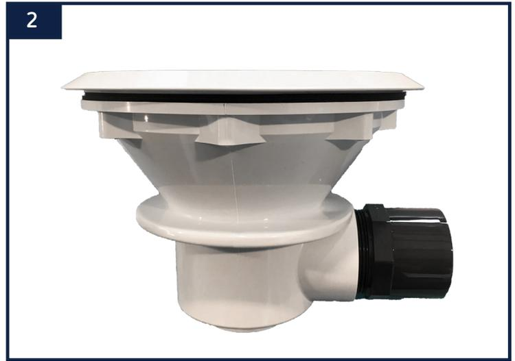
Vissez votre embout fileté PVC male Ø50 2" à votre bonde de fond comme indiqué sur la photo ci-dessus. Pour une fixation optimale, collez ces 2 éléments entre eux à l'aide de la colle PVC. Ajouter du téflon sur le filetage du raccord bonde de fond. Suivez ensuite les indications page 7 pour installer correctement votre bonde de fond.
