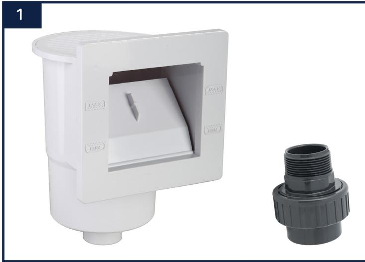
L'un de vos raccords Union PVC male Ø50 mm 1'1/2 sera à raccorder à votre skimmer. Ce raccord vous permettra de raccorder à l'aide d'un tuyau PVC rigide et d'un tuyau pression souple votre skimmer à votre vanne de skimmer située en amont de votre pompe de filtration.
