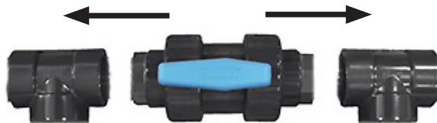
Une fois son emplacement déterminé, démontez entièrement votre By-Pass, puis encoller, à l'aide d'une colle spéciale piscine pour canalisations PVC rigide et PVC souple, les 2 raccords Té (arrivée et refoulement) à la vanne centrale de votre système. Pour réussir facilement votre collage, demandez conseil à votre revendeur.
