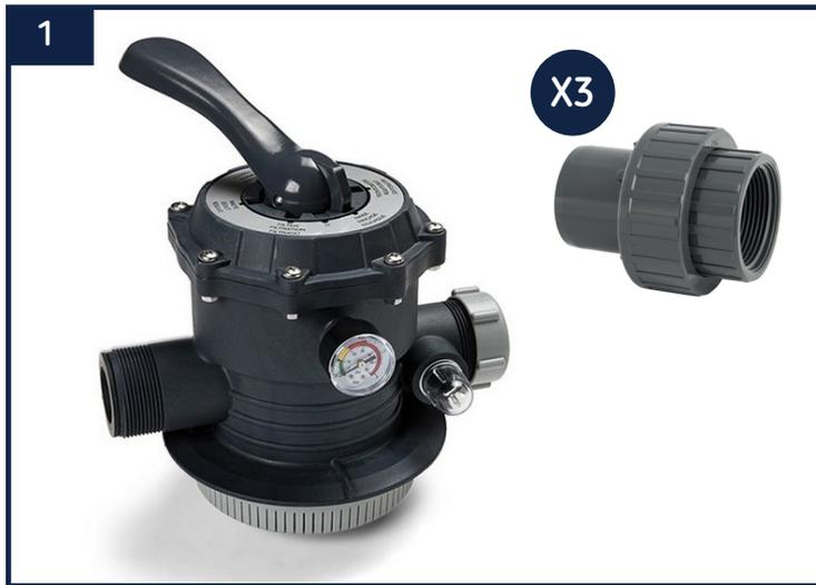
Les 3 raccords union PVC 3 pièces mixte Ø63/50 2" sont à raccorder à la vanne multivoies de votre filtre à sable. Ces raccords vous permettront de raccorder votre pompe de filtration et votre buse de refoulement à votre filtre à sable à l'aide de tuyaux PVC rigide et de tuyaux pressions souples. La 3<sup>ème</sup> sortie de votre vanne 6 voies vous permettra de brancher votre tuyau de vidange.
