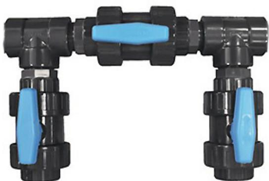
Pré-assemblez votre kit By-pass sans collage puis positionnez-le sur le tuyau de refoulement afin de déterminer la place qu'il occupera une fois installé. Reportez ensuite sur votre tuyau de refoulement ses dimensions en retirant 6 cm (ex : si votre kit By-Pass mesure 50 cm de long, reportez 44 cm sur votre tuyau de refoulement).
