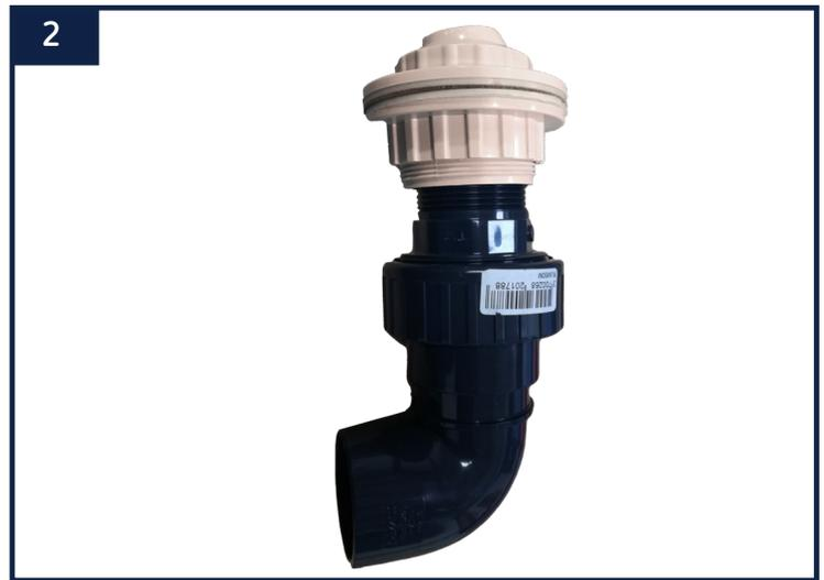
Dévissez le raccord 32/38 présent sur votre buse de refoulement et remplacez-le par le raccord Coude 90°PVC male femelle 50X40X40, pour que le tuyau descende correctement. Afin d'assurer une parfaite étanchéité, il sera nécessaire d'appliquer au préalable un joint d'étanchéité en téflon sur le filetage de votre raccord. Pour réaliser correctement cette étape, n'hésitez pas à demander conseil à votre revendeur.
