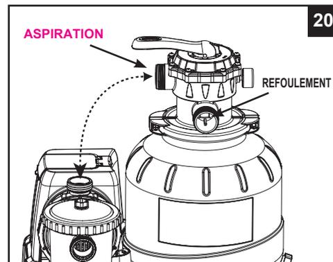
2. Placez un joint en L (11) sur le port d'aspiration de la vanne 6 voies et un autre sur le refoulement de la pompe. Raccordez ces deux ports avec le tuyau de transfert (13) (voir dessin 21).
