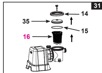
5. Videz et rincez abondamment le panier en utilisant un tuyau d'arrosage, utiliser si nécessaire une brosse plastique pour déloger les impuretés du pré-filtre. Ne pas utiliser une brosse en métal.
