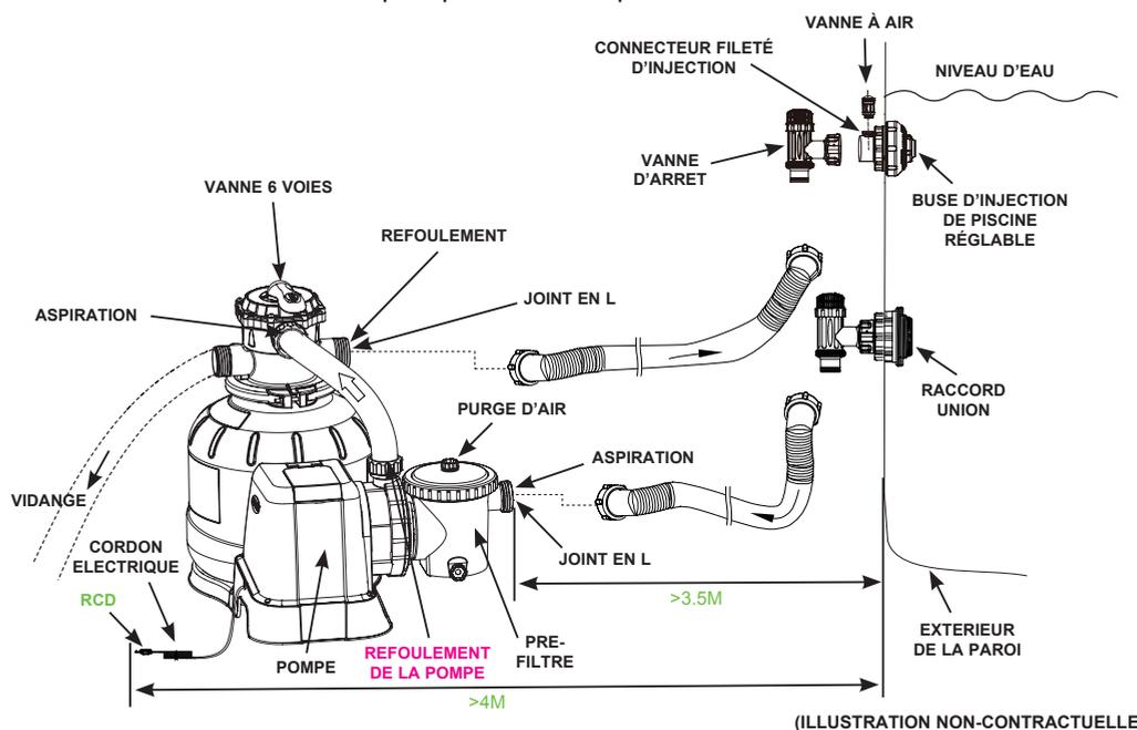
Conformément à la norme internationale, CEI 60364-7-702, pour toute installation électrique de piscine et autres équipements de bassins, les distances d'installations suivantes doivent être respectées :
